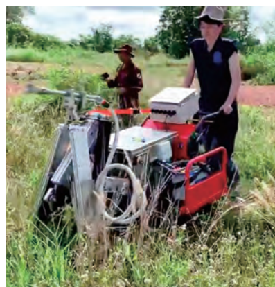
DMR-5は走行形態に変形し 荒地にも持ち込むことができます
