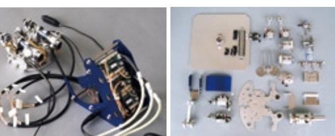
ステレオアクティブカメラ 部品構成 人体頭部組立 (基本) キット 全パーツ
